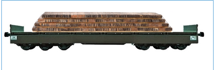
6-achsiger Schwerlastwagen Bauart Samms 4860 DR (Epoche IV) Bahndienstwagen des Bauzuges der RBD Magdeburg, abgeklappt, beladen mit Holzschwellen, grün-grün-schwarz NW 52072 TT 69,90 €
