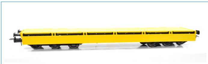
6-achsiger Bauzugwagen der Bahnbaugruppe Bauart Samms-u 454 der DB AG (Epoche VI) gelb-schwarz-schwarz, abgeklappt, unbeladen NW 52232 TT 54,90 €
